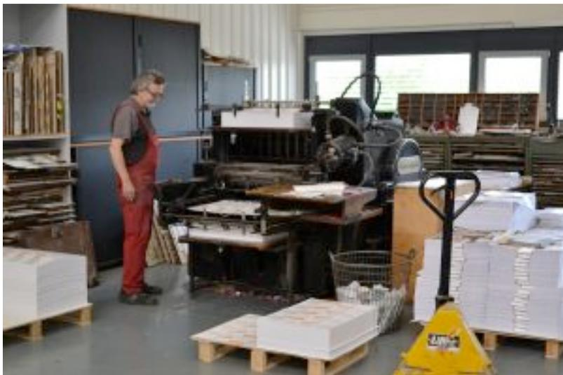
**Nostalgie pur.. Stanzarbeiten an einem originalen Heidelberger Zylinder (Buchdruckmaschine) aus den 60er Jahren**
