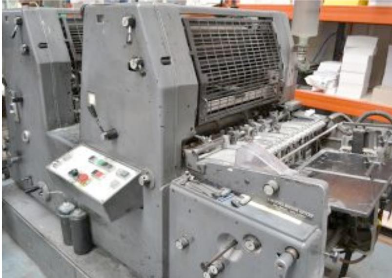
**Heidelberger GTO-Z Druckmaschine aus der Baureihe der 80er Jahre, die bis heute im Betrieb eingesetzt wird**
