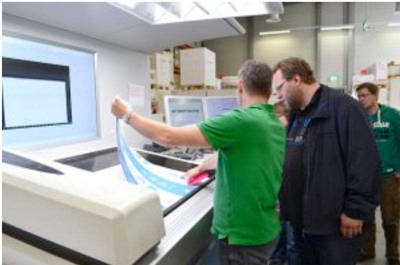
**Qualitätskontrolle am Leitstand einer Bogenoffsetmaschine**
