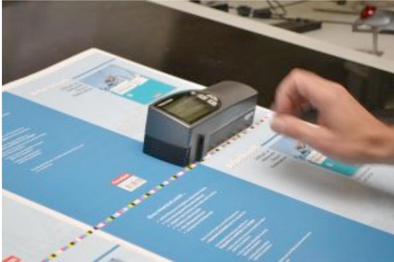
**Messung der Farbdichte mit einem Densitometer**
